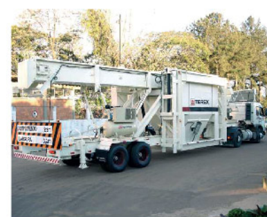
Мобильный саморазвертывающийся силос объемом 25 м 3
