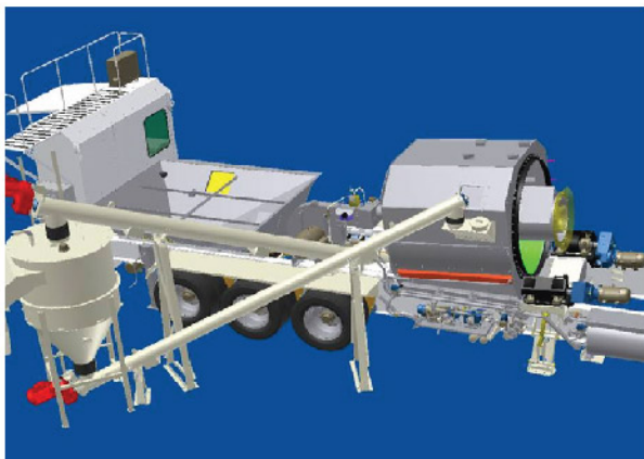
Система сбора пыли в загрузочный бункер объемом 1 м 3
